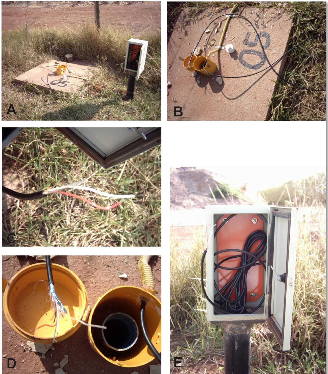
Figura 27 - Furto dos equipamentos eletrônicos de monitoramento de nível do poço 5. A, B) situação geral encontrada após furto; C, D) detalhes da extremidade do cabo do transdutor cortado; E) detalhe da caixa metálica que armazenava o data logger.
