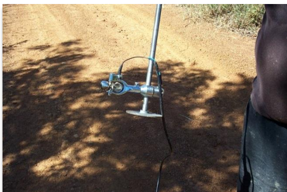
Figura 13 - Molinetes hidrométricos utilizados para medição da velocidade de fluxo de águas superficiais.
