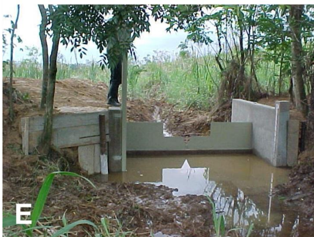
Figura 12 - Estação Cana: (A) vista da bacia; (B) detalhe do córrego; (C) medições da seção transversal do córrego; (D) detalhe da régua instalada; (E, F) vertedor instalado.
