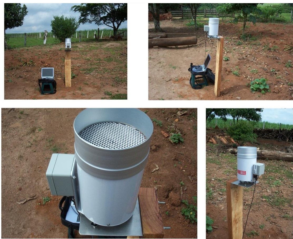
Figura 7 – Pluviógrafo para monitoramento das chuvas e notebook para transferência de dados.
